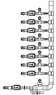
El dispositivo centraliza la instrumentación para despachar oxidante a presiones y flujos controlados en un distribuidor múltiple lo suficientemente robusto y a la vez ligero, de tal manera que permita su movilidad, confiriéndole versatilidad para trabajar en múltiples configuraciones y con distintos reactivos.
